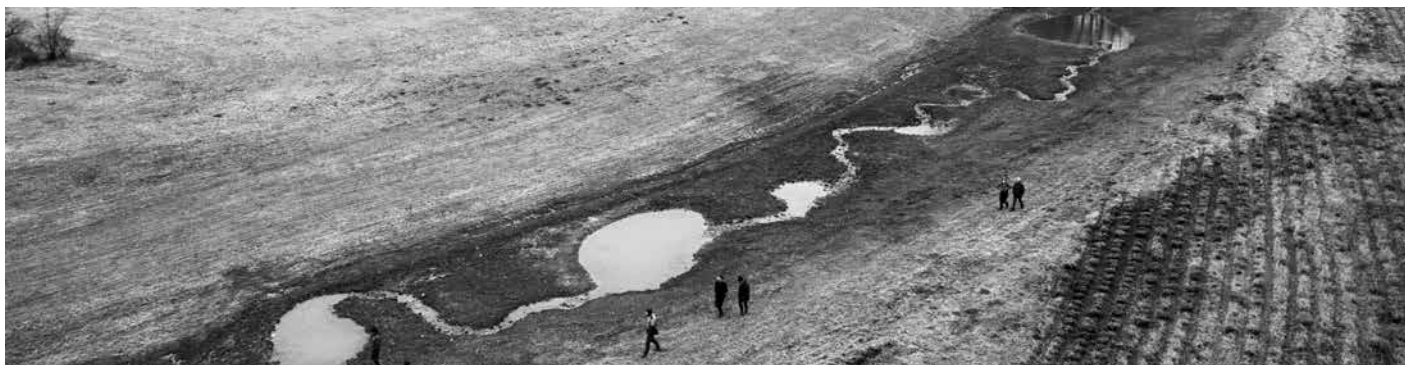
Revitalizace koryta potoku, obnovení rybníčku, vytvoření jedenácti tůní, protierozní meze a zatravněné údolnice v zemědělsky obhospodařovaném území. V Hartmanicích zadrží díky opatřením vodu v krajině ve větším množství a po delší dobu, sníží erozi a zajistí útočiště pro obojživelníky. Autor: Martin Matěj
